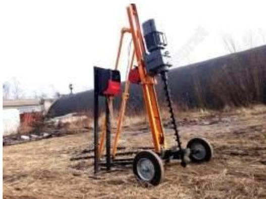
Установка буровая УКБ-12/25-02 является модификацией базовой модели УКБ-12/25 и предназначена для бурения вертикальных скважин глубиной до 15 м. шнековым способом при поиске съёмке, картировании, сейсморазведке и других работах аналогичного характера в труднодоступных районах или стесненных условиях.
