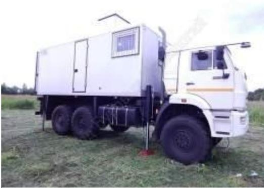
Завод Буровых Технологий производит серийный выпуск установок статического зондирования УСЗ-20.ZBT на базе шасси 43118
