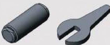
Для обеспечения спуско-подъемных операции при развинчивании снаряда используют вилку подкладную
