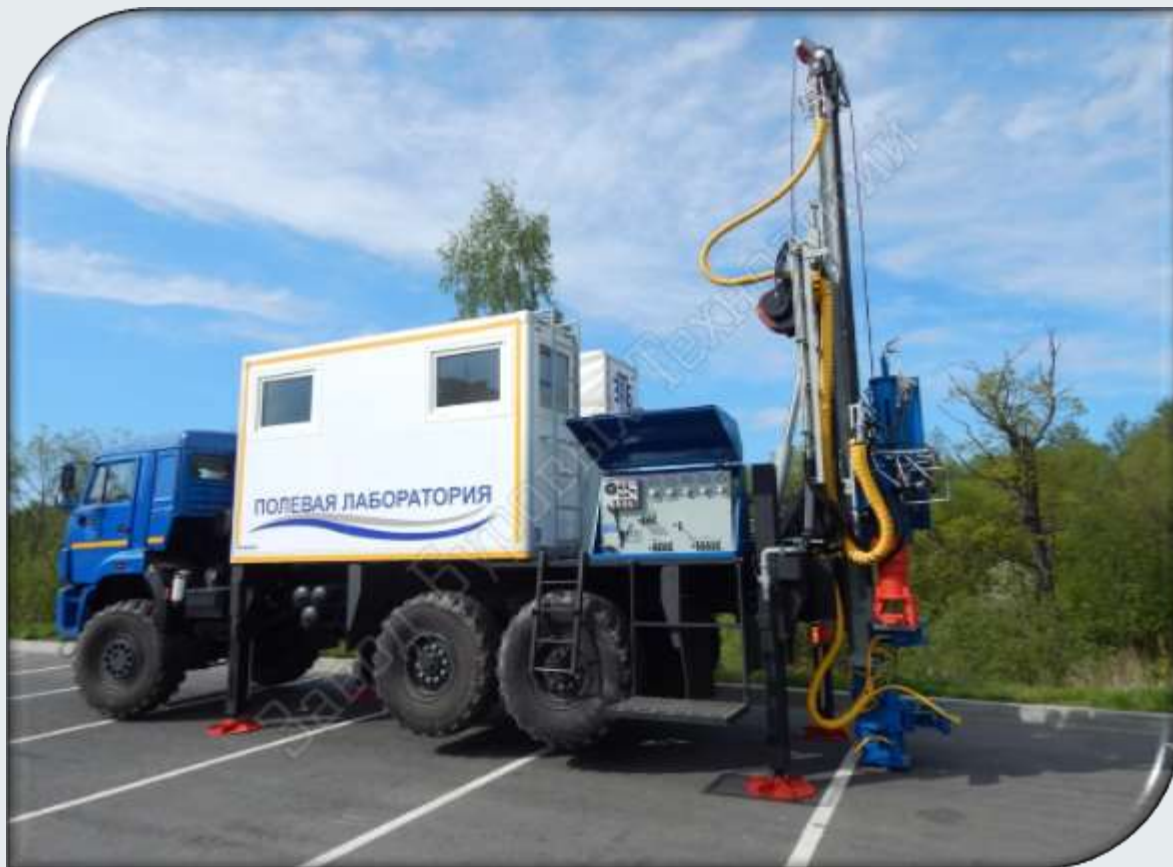
Буровая установка УРБ-600 “Изыскатель”
